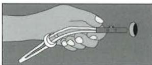
DRILL HOLE. HOLD TOGGLE FLAT ALONGSIDE PLASTIC STRAPS, SLIDE THROUGH HOLE.
