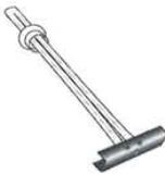
4. TOGGLE BOLT FOR HOLLOW BLOCK FACE MOUNTED
